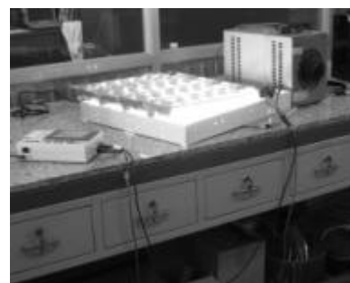
圖 7 20Wx4 燈具量測情形
