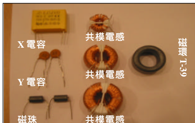
圖 1 傳導及輻射抑制對策元件
