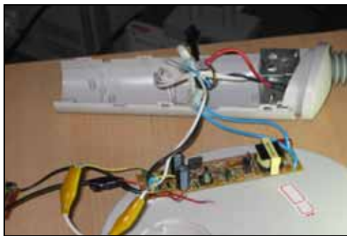
圖 3(A)電子基板拔除 EMI 對策元件
