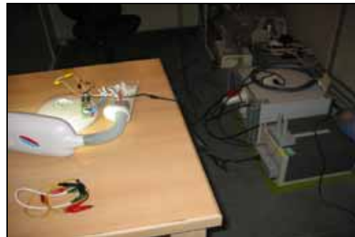
圖 3(B)作傳導性電壓干擾測試
