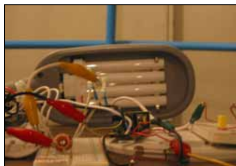
圖 11 差模濾波器輻射測試
