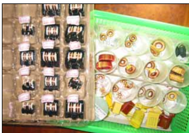
圖 5 X 電容及 2PIN、4PIN 差模電感規格品
