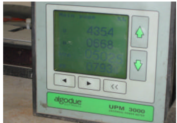
圖 8 控制 RL 投入量可操作發電機運轉在額定輸出及 PF=0.8 下
