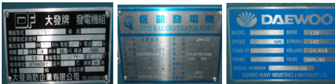
圖 1 機組標示、發電機頭標示、引擎(德製)標示
