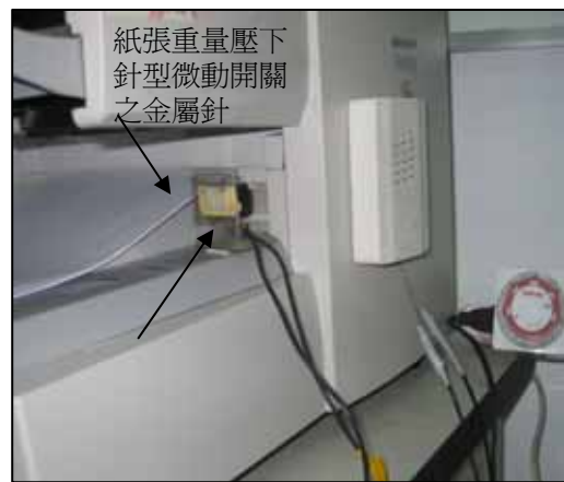
圖 5 單張紙張重量即可壓下微動開關
