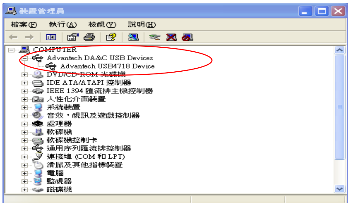
圖 4.1 Window 作業系統透過 DLL 認知 USB-4718 硬體
