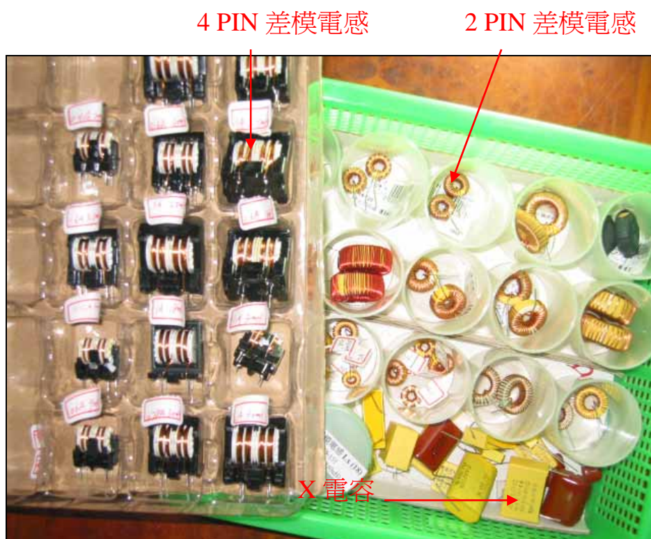
圖 4.10 X 電容及 2PIN、4PIN 差模電感規格品
