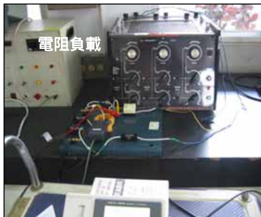
圖 2 二極體交流側電流量測
