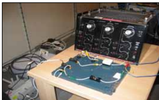
圖 4 二極體高頻傳導電磁干擾量測
