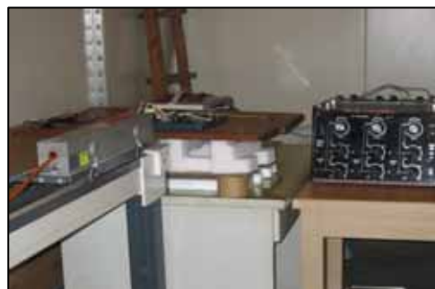
圖 5 二極體高頻輻射電磁干擾量測
