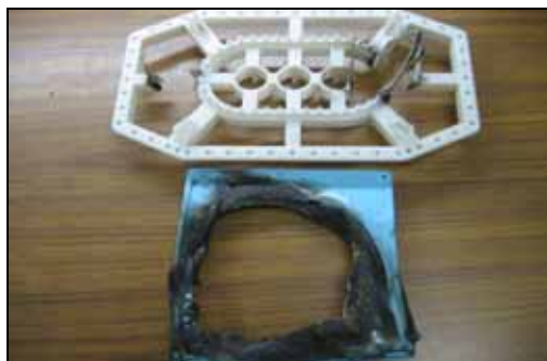
圖 4 捕蚊盒及電擊網支撐座起火燃燒 (不合格例)
