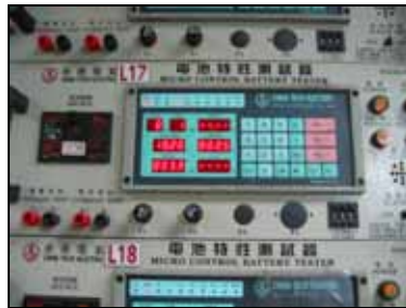
圖 6(A)電池置於 40^{\circ}C \sim 45^{\circ}C 水槽 (B)同圖 2 充放電控制設備
