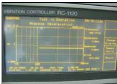
圖 5(A)振動試驗機運作監測 (設定 a=7g , v=\pm(50 \leftrightarrow 500 次/秒)
