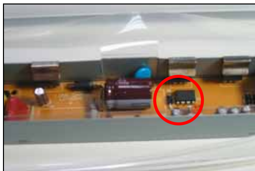
圖 7 T5 14Wx4 辦公室燈具量測 圖 8 電子安定器的 APFC IC(KOREA IP3102L)
