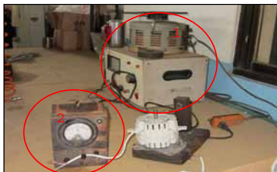
(圖五)1967年風扇用電源1與測試電錶2
