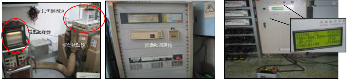
圖 5(A)振動試驗 (B)設定 a=3g , v=\pm(30\leftrightarrow 35 次/秒) (C)以 I_s=272A 放電 1 分, 9.19V
