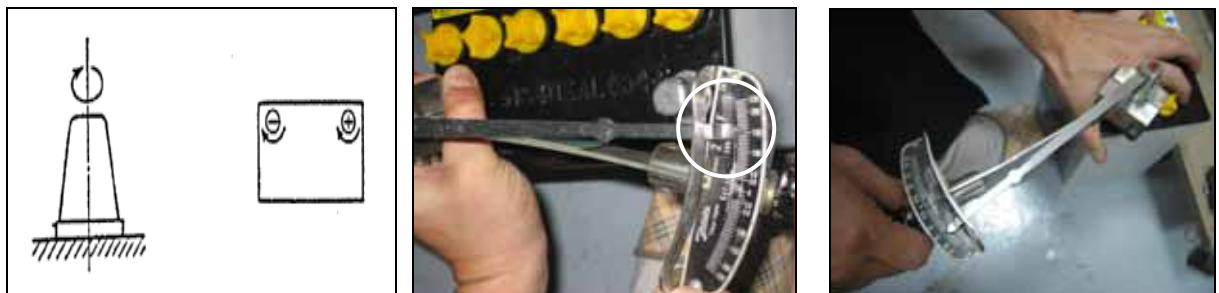
圖 6 (A)扭力鉸手旋轉方向 (B)正端子施力矩 150kgf (C)負端子施力矩 150kgf
