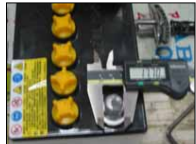
圖 8(A)CNS422 T_3 端子規範 (B)正端子直徑量測:19.46mm (C)負端子直徑量測:17.70mm
