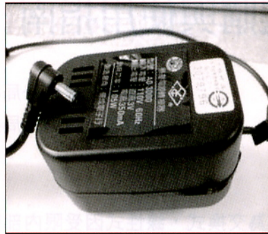
圖 3 線性式整流器外觀 (具經濟部標準檢驗局檢驗標識)
