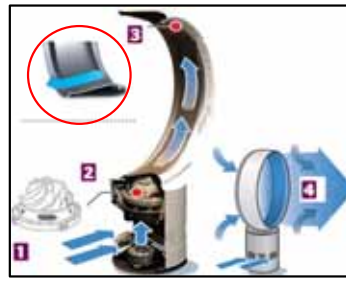
(b)鼓風輪風扇噴流系統(電動部份)
