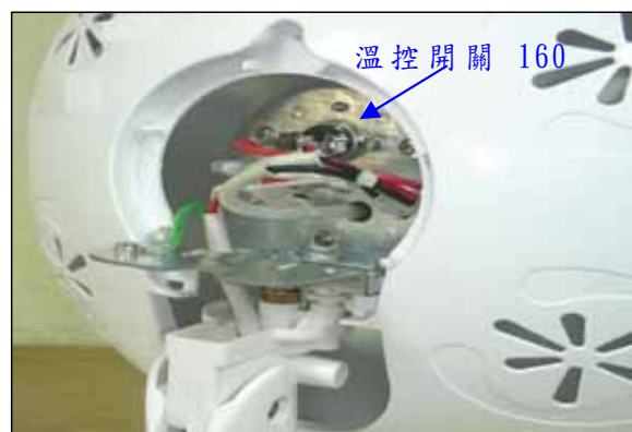
(b)機頭後金屬蓋內超溫斷電保護
