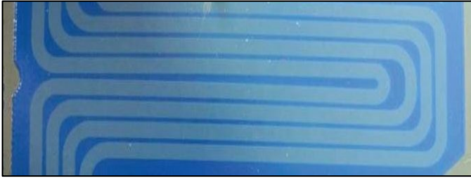
(d)電漿膜與印刷在基板上的銀軌 圖 2 電膜式電暖器內部結構與電膜架構 (圖片來源：嘉儀國際公司代理之德國產品)
