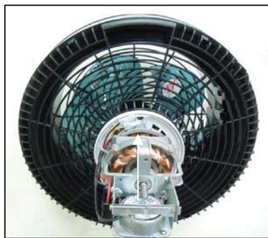
(a) 馬達及後蓋圓錐結構(前蓋已拆)
