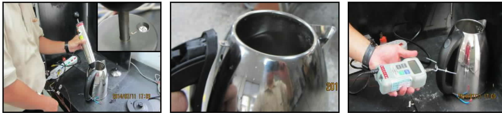
a.衝擊鎚試驗(0.5 焦耳能量) b.螺絲鬆脫試驗(拆裝螺絲) c.拉力試驗
