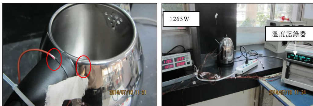
a.熱電耦線黏貼在把手及與壺體接觸處 b.正常溫升試驗情形 圖 2 正常溫升測試 (實驗拍攝)
