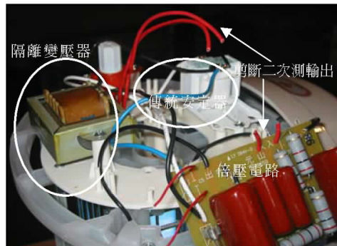
圖 6B (狀況二)僅燈管輸出下量測 表 2B (狀況二)僅燈管輸出低頻諧波
