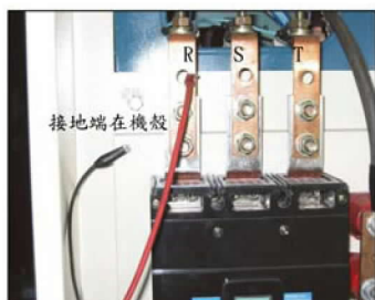
圖 12 測 R 相絕緣電阻
