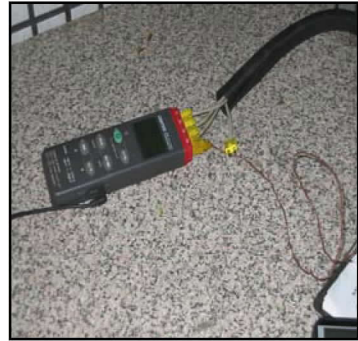
圖 11 具四組熱電耦線之記錄器
