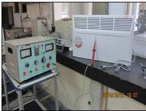
c. 絕緣耐電壓測試
