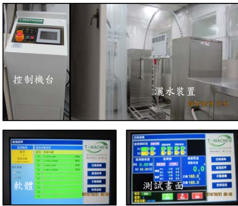
a. IPXn 防水等級測試裝置 (控制台/擺動水管裝置/軟體)
