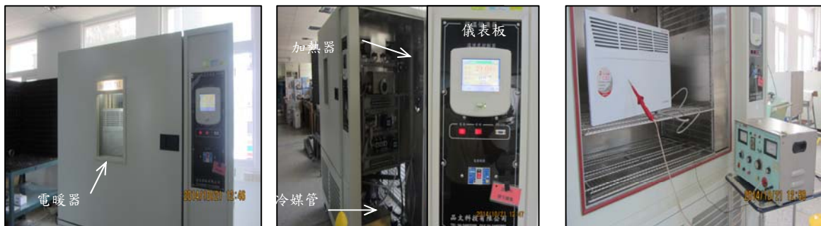
a. 恆溫恆溼箱外觀及其溫濕控制的加熱器與冷媒管
