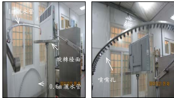
b. IPX4 測試情形(半徑 1M 灑水管/中央旋轉台) (牆壁置放為半徑 0.6M 灑水管, 適用 IPX2~3 測試)
