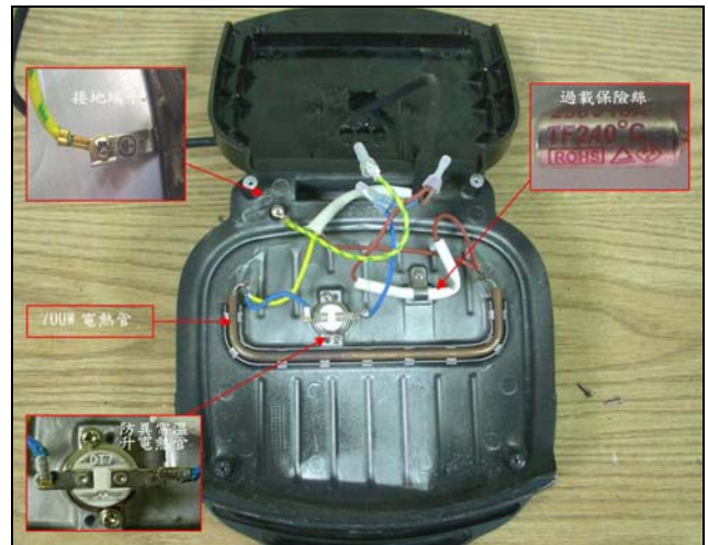
b. 機座內部配線與鐵板底部(嵌入電熱管)
