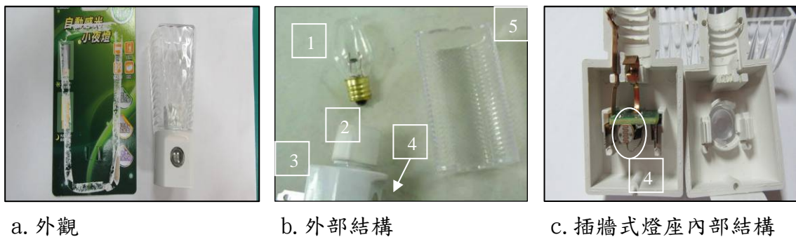
圖 2 110 V、7 W 自動點滅感應式小夜燈結構(購自樣品)
