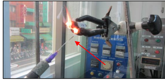
b. 燈座耐燃試驗，針燄測試 10 秒止
