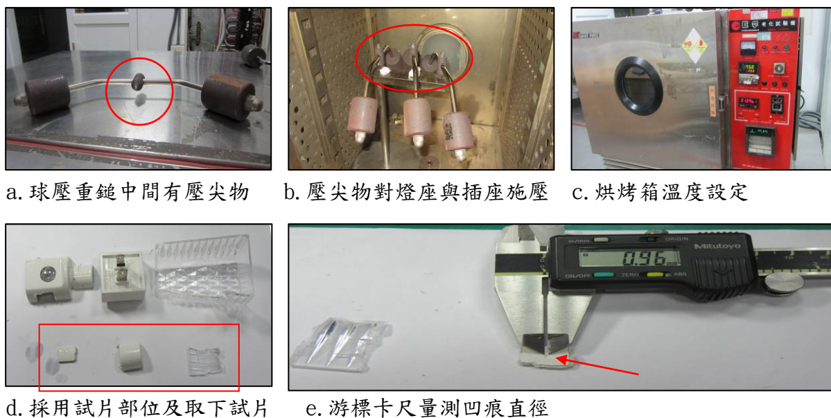
圖 3 燈罩、插座、燈座的耐熱試驗與試驗設備(實驗拍攝)
