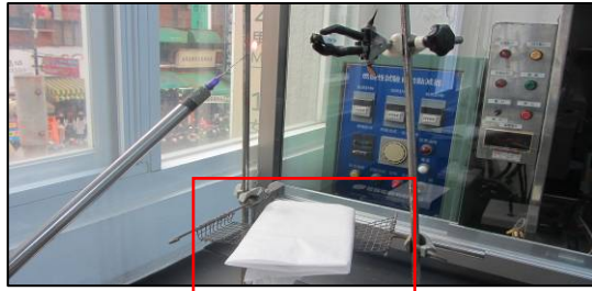
a. 針燄試驗設備(底下鋪棉紙)
