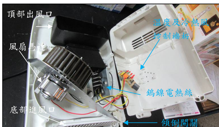
b. 內部架構(進風口、出風口、風扇馬達、電熱絲)
