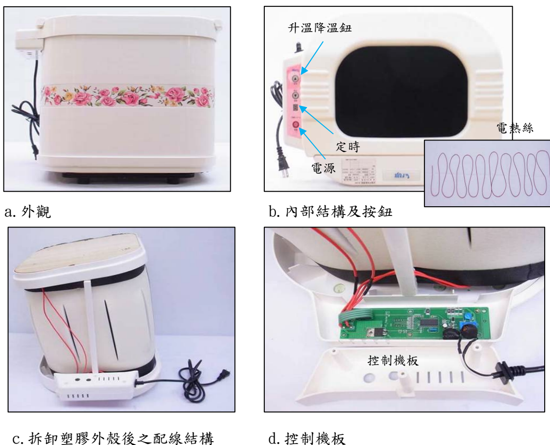
圖 2 電熱發熱之乾式泡腳機外觀與內部結構(購自樣品拆解)
