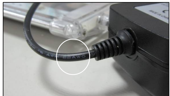
c. 近整流器二次側的內部配線 22 AWG
