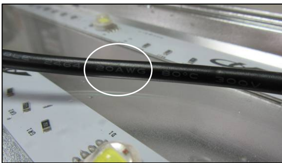
b. 近燈具端的內部配線 20 AWG
