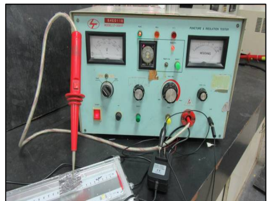
圖 8 絕緣耐電壓測試情形(耐電壓 500V)
