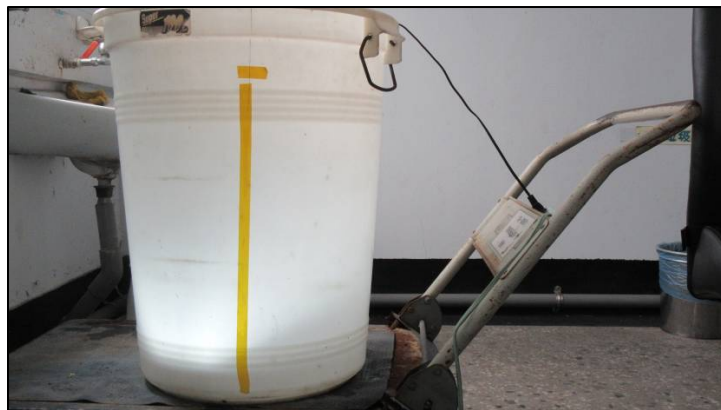
圖 7 水族箱燈具的 IPX7 水密試驗
