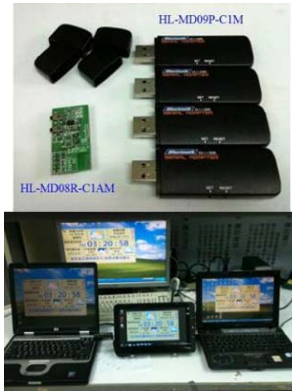
圖 4-18 採行 hotfile MSPP Solution 進行測試之藍芽子母鐘，因其為 USB 界面，故僅能搭配 Windows 終端使用
