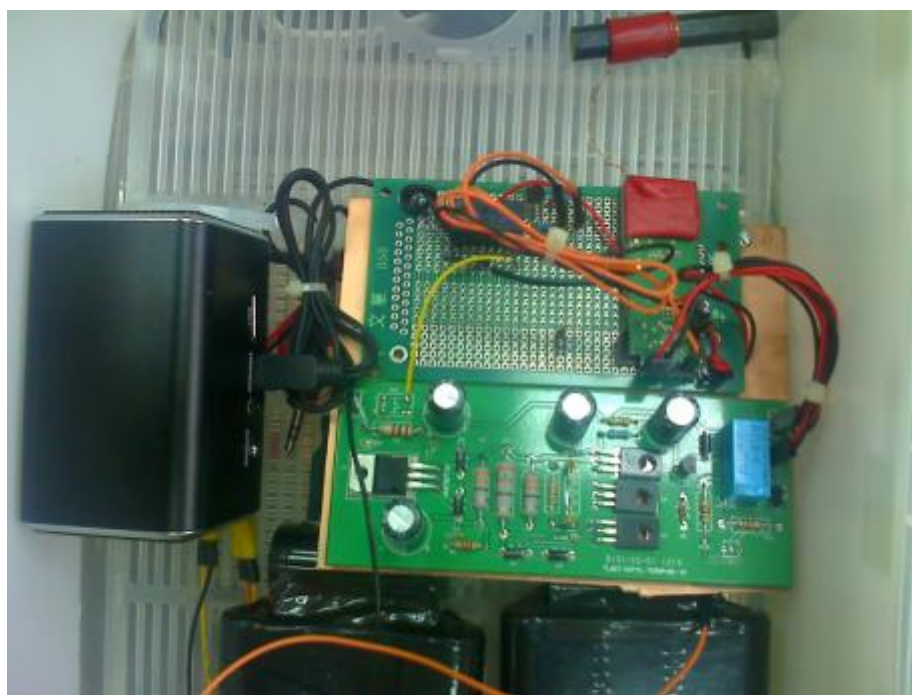
圖 4-24: 低頻轉語音訊息電路，採用 LDO 電源簡化佈局
