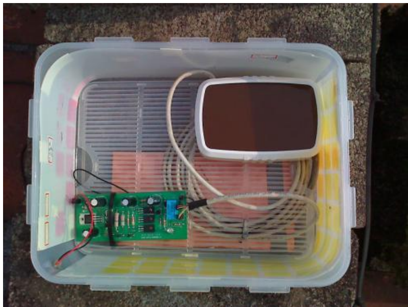
圖 4-21: 置於中華電信研究院 C 棟頂樓之藍芽母鐘，搭配 LDO 電源
