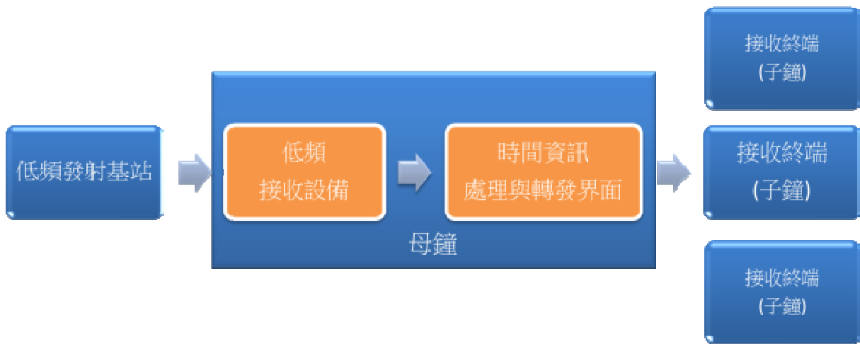
圖 4 - 16: 雙模子母鐘之運作架構
