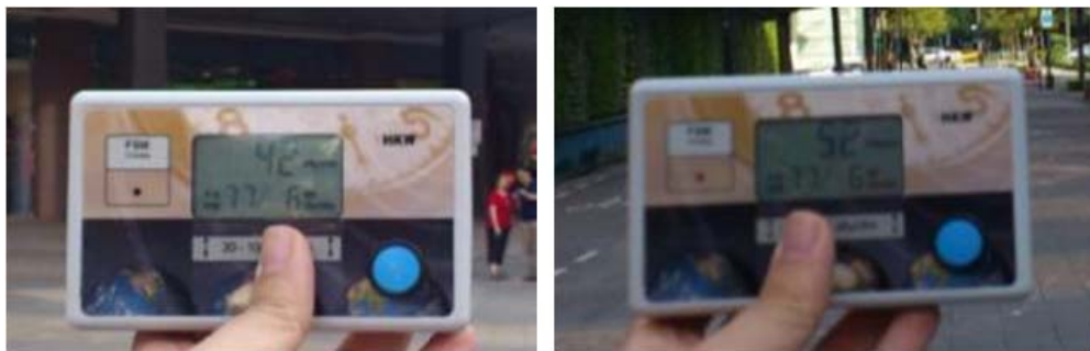
圖 4-15：於信義區百貨商圈之東西向道路量測得場強 42dBuV/m；於同地點之南北向道路量測得場強 52dBuV/m
