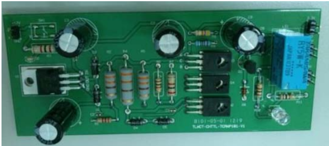
圖 4-20: 藍芽母鐘之 LDO 穩壓電源成品
