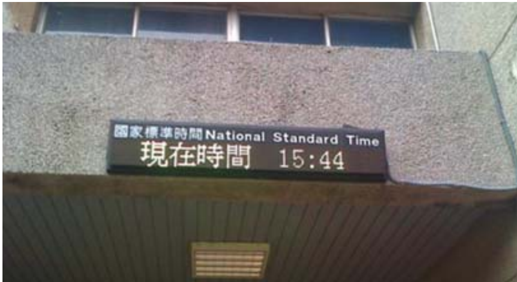
圖 4-22: 具藍芽接收端之大型 LED 子鐘
