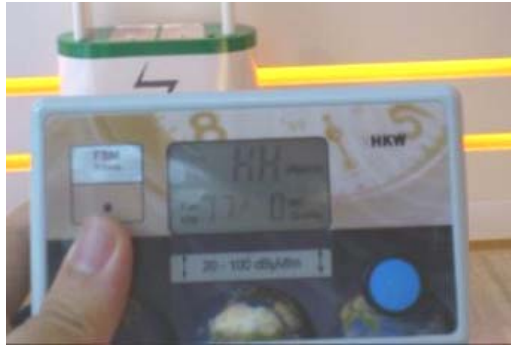
圖 4-14: 77.5kHz 場強儀於室內量測得高強度干擾訊號
