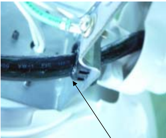
電暖器左擺電線在護套位置
