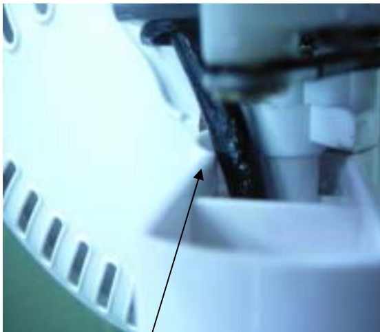
電暖器右擺時通過與外殼內部角邊摩擦位置
