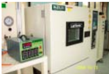
打火機試驗設備—蒸氣壓力測設備及恆溫箱
