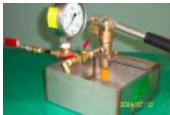
打火機試驗設備—燃料槽耐壓試驗機
