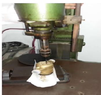
圖 2 鑽孔機鑽取銅合金屑
