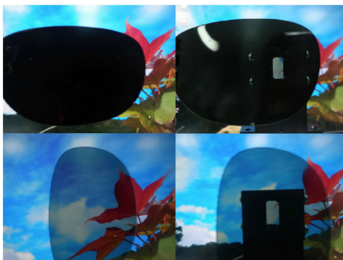
圖3 去極化鏡透過偏光鏡觀察可清楚看到光源
