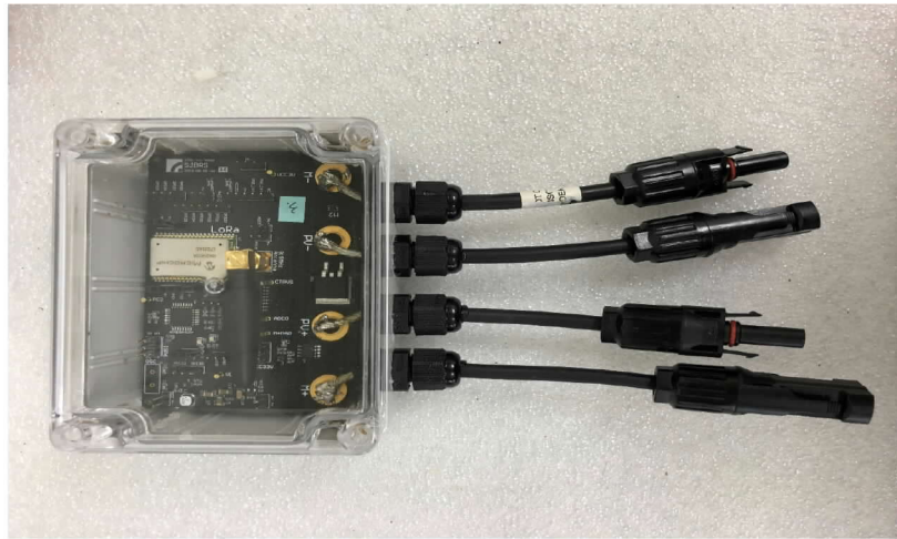
圖 8 工研院開發 LoRa 具 RS 功能之模組級太陽光電電池智慧感測模組
