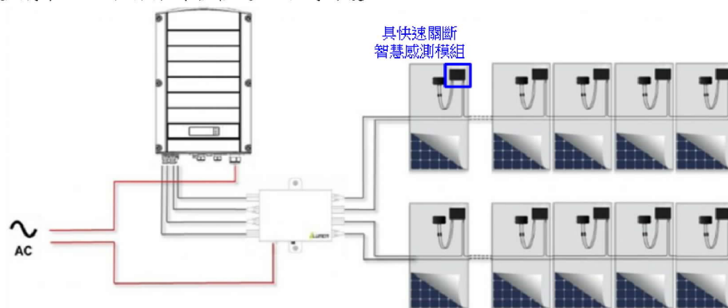
圖 2 智慧感測模組外接建置方式
