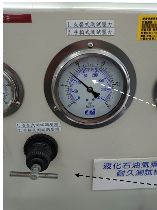
圖 2 測試機台旋轉條壓閥與壓力表
