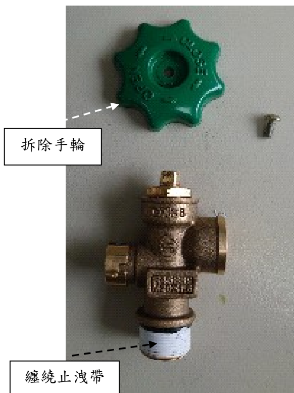
圖 1(a) 手輪式鋼瓶閥機構 (耐久試驗)
