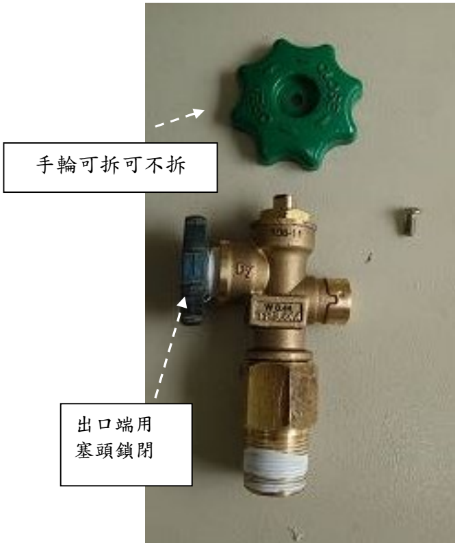
圖 6(a) 手輪式鋼瓶閥機構 (氣密試驗)
