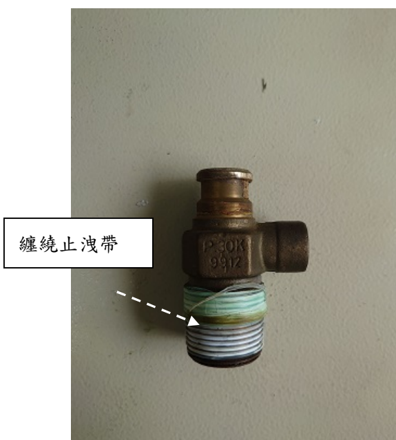
圖 4(a) 夾套式鋼瓶閥機構 (耐久試驗)
