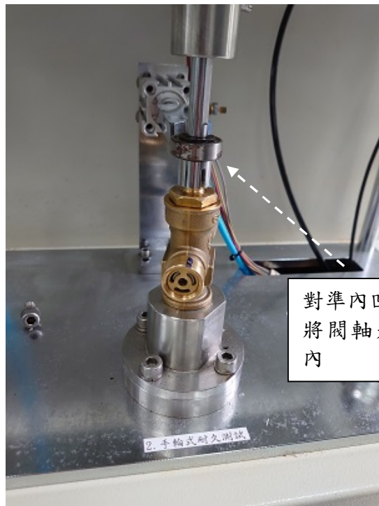
圖 1(c) 手輪式鋼瓶閥軸套入測試機台治具 (耐久試驗)
