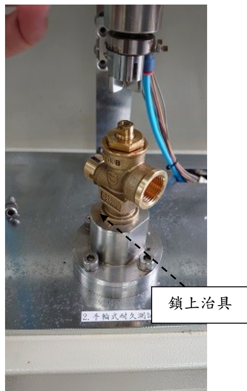
圖 1(b) 手輪式鋼瓶閥鎖上測試機台 (耐久試驗)
