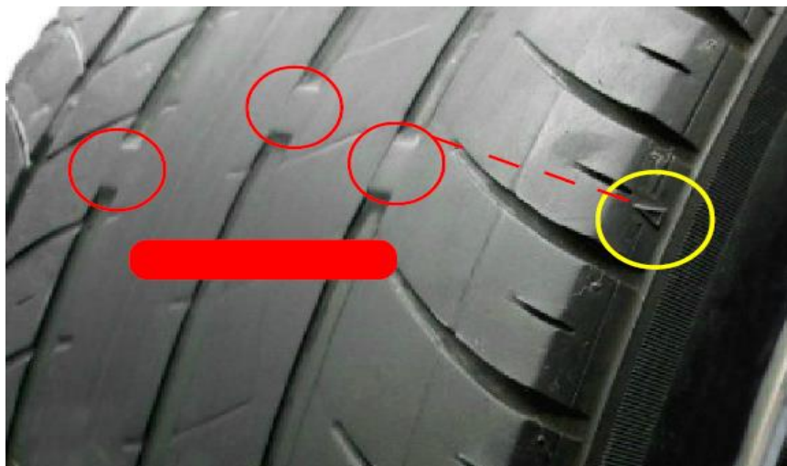
圖 3 輪胎溝紋已磨耗至指示平臺 (須更換新胎)
