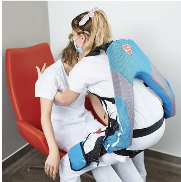
圖 5 肌耐力增強型產品照顧應用(氣壓式)[3]
