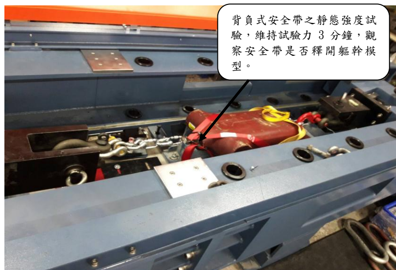
圖 2 背負式安全帶之靜態強度試驗
