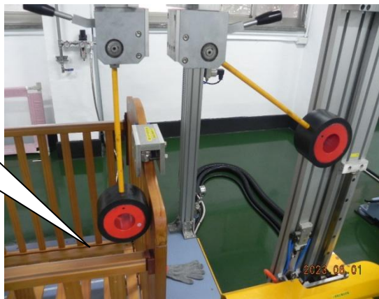
圖 3 床角衝擊試驗
