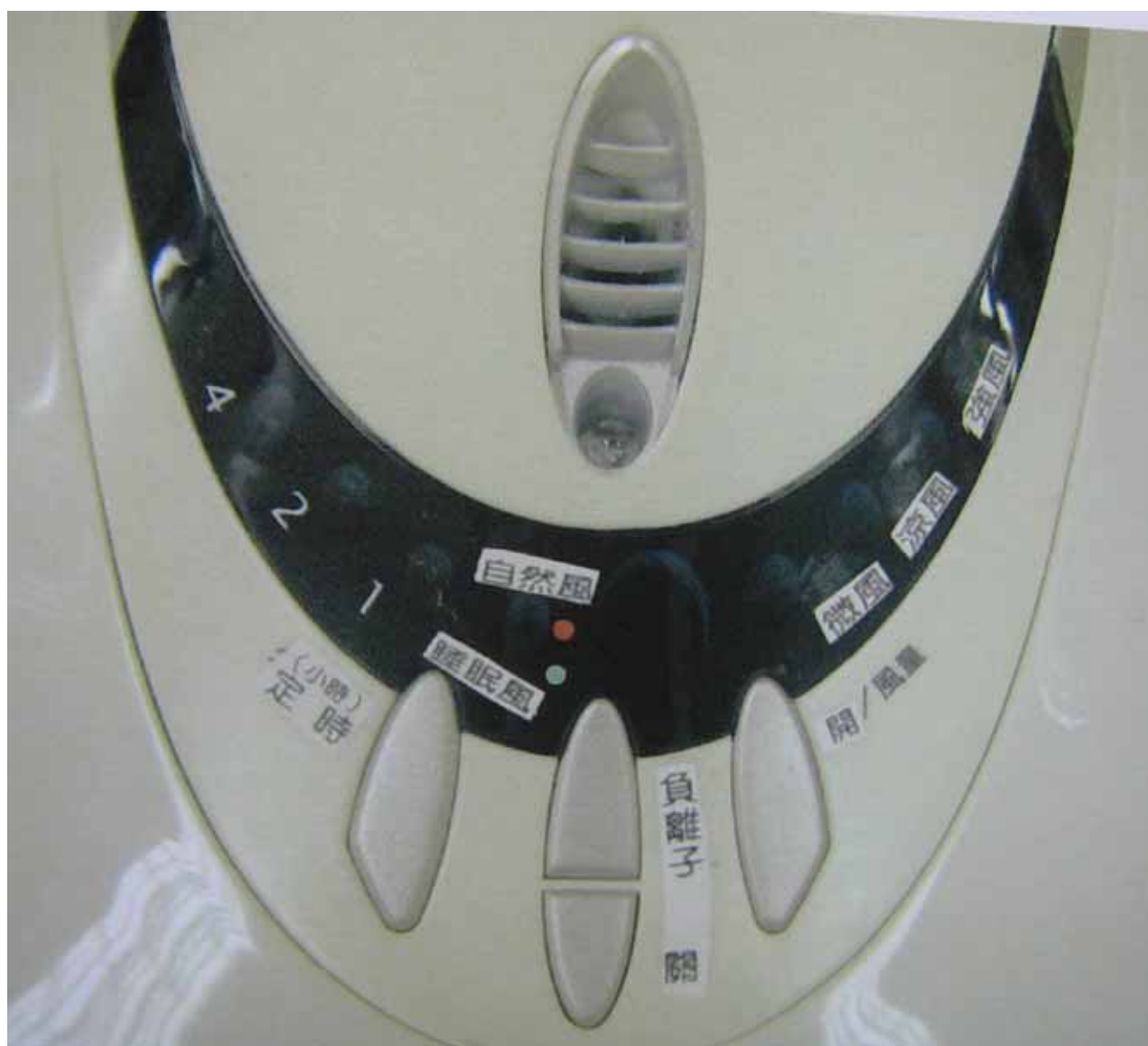
圖 1.1 有電子控制機板電扇之控制面板
