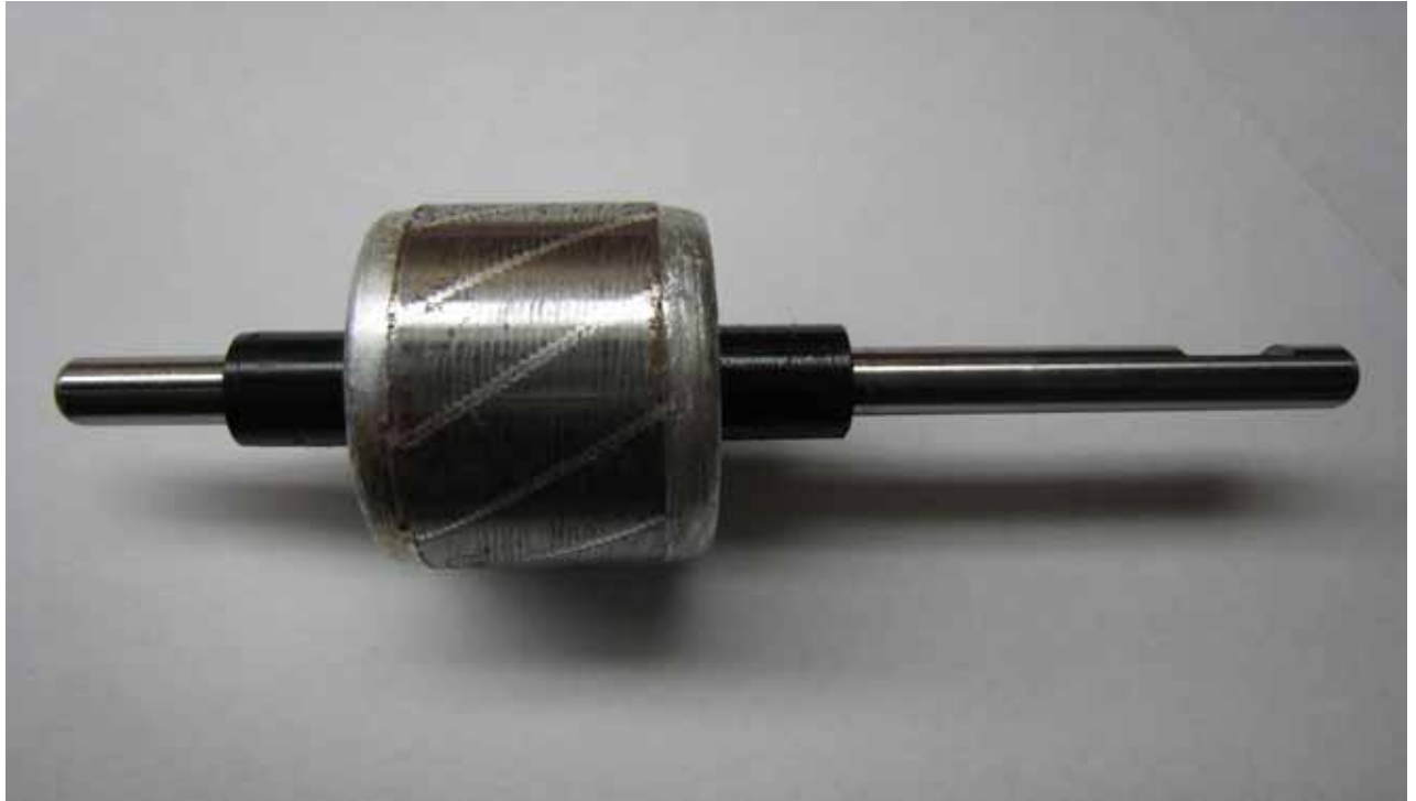
圖 2.9 電扇使用單相永久性電容分相式感應馬達實體圖(轉子)
