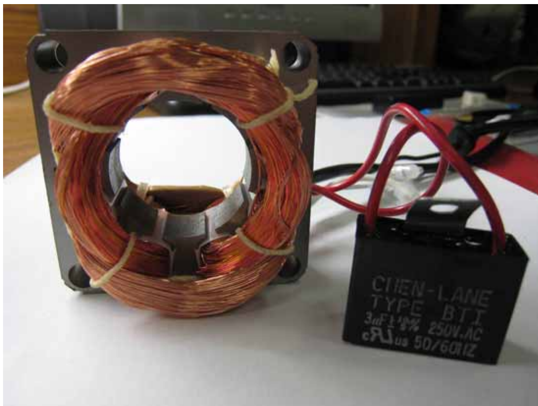
圖 2.8 電扇使用單相永久性電容分相式感應馬達實體圖(左為馬達定子)
