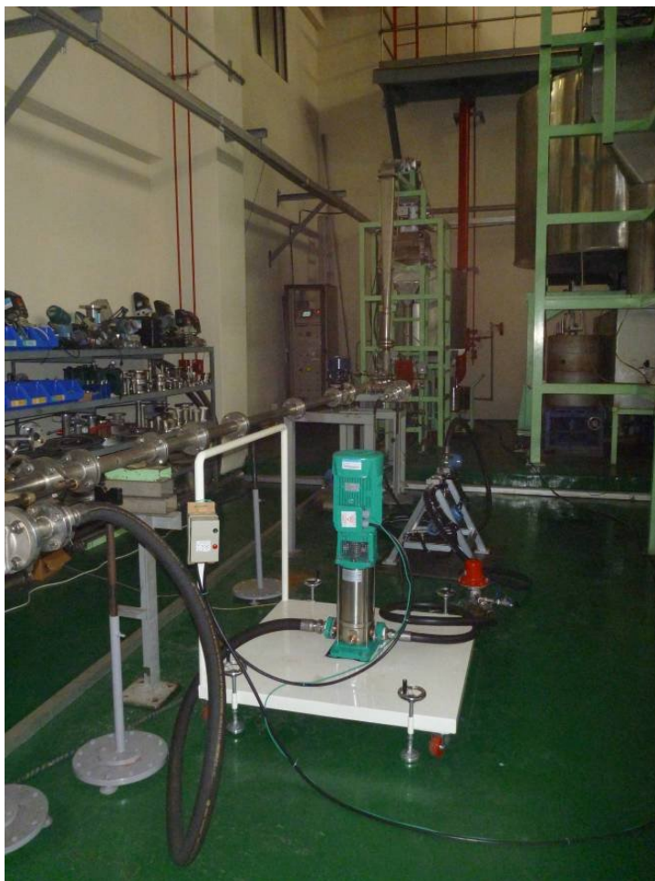
圖 4-4 液化石油氣流量計追溯性研究計畫質量式流量計測試配置
