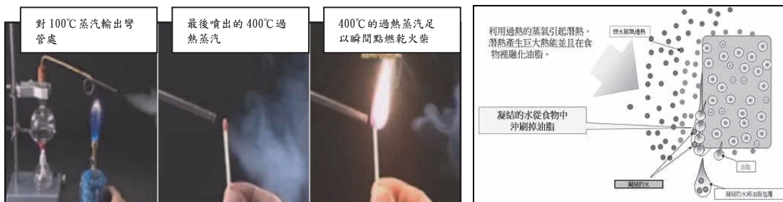
a. 過熱蒸氣特性足以使乾火柴點火，故可用來燒烤食材，並營造外酥內嫩及不乾燥口感 b. 過熱蒸氣可穿透食材內部煮食，另蒸氣可包覆食材滲出的油鹽
