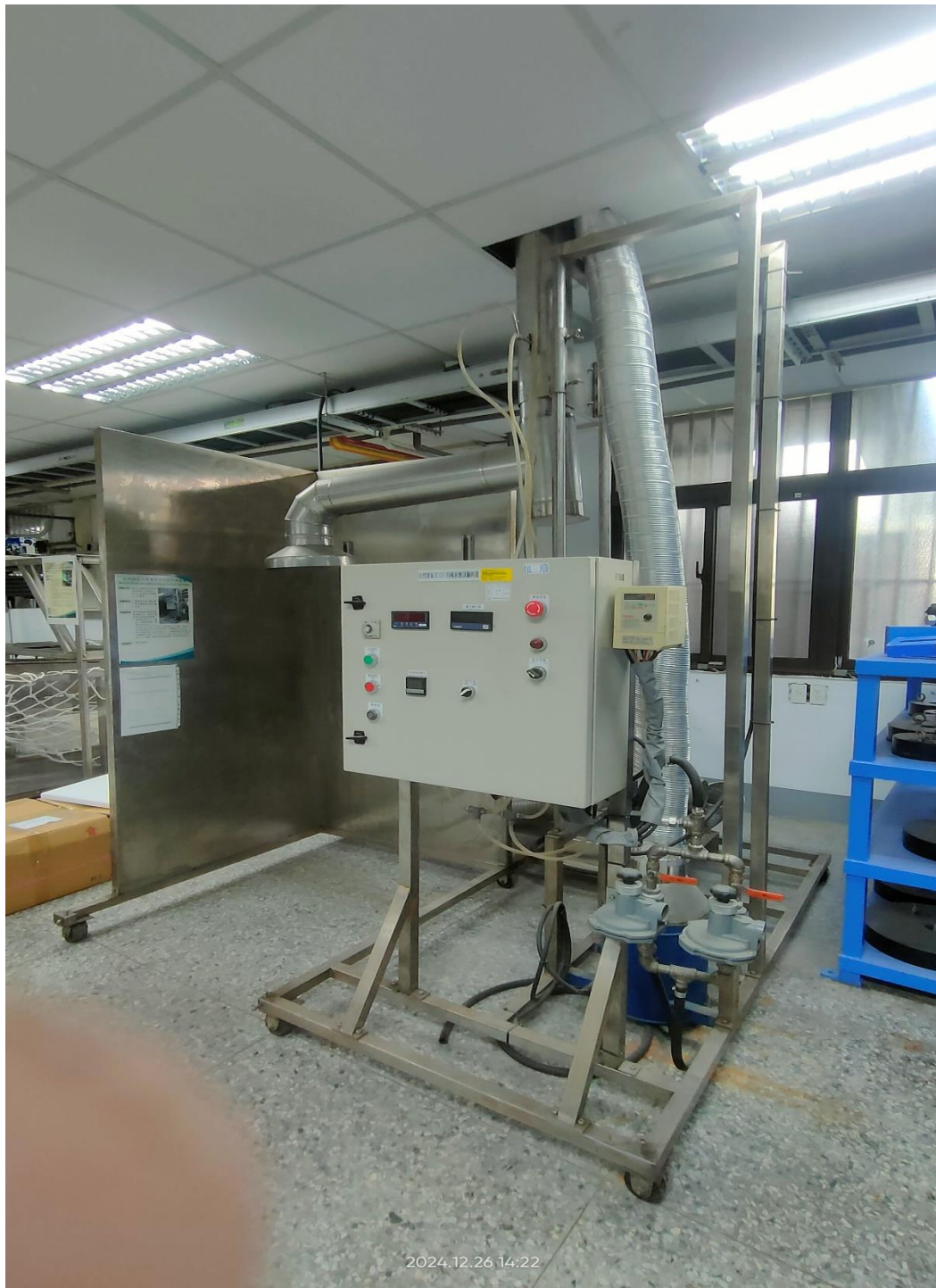
圖 1-自然排氣式有風狀態試驗裝置
