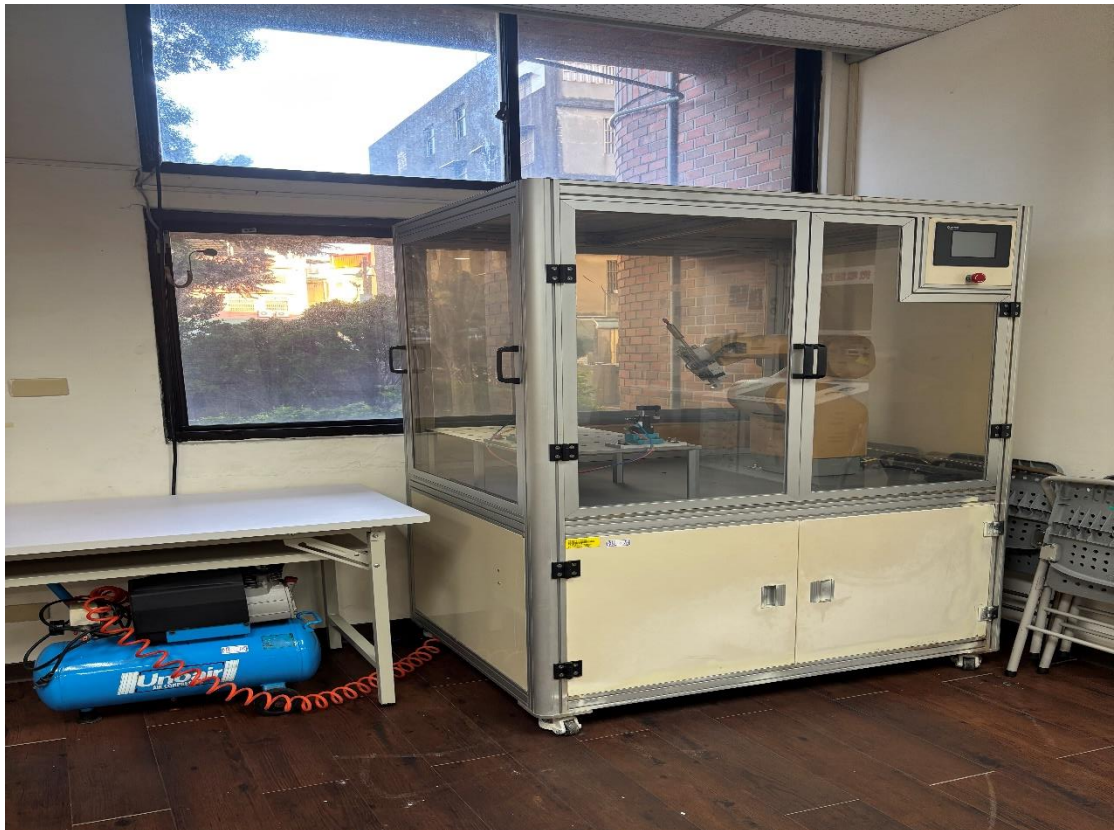
圖 4-氣體測漏器(器具開關鈕反覆測試設備)
