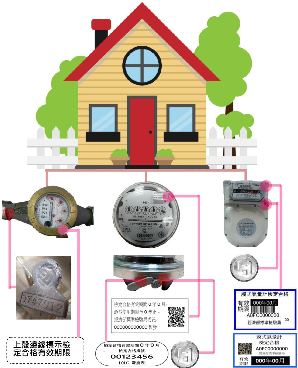
＊家庭用法定度量衡器，包括家用三表，即水量計(水表)、電度表(電表)、膜式氣量計(瓦斯表)，請認明有檢定合格印證「**同**」字封印，合格的度量衡器具才能保障交易公平喔！
