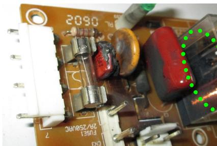
圖 2-2 ↑ 除濕機控制電路電源濾波用途之事故案例
