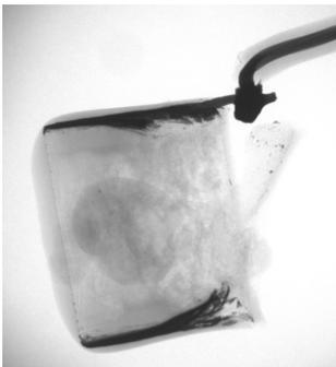
圖 3-37 ↑ 樣品 2 燃燒後之殘骸 X-ray 正面照片
