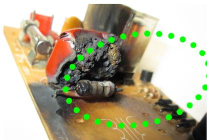
圖 2-1 ↑ 除濕機控制電路電源分壓用途之事故案例
