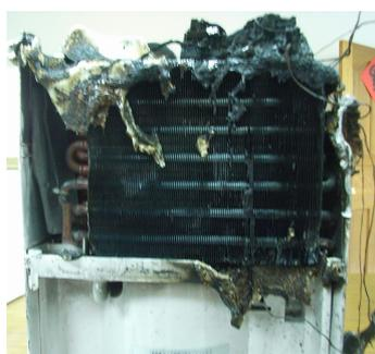
圖 2-31 ↑分壓電容類型事故除濕機案例 1 照片（上方正面）
