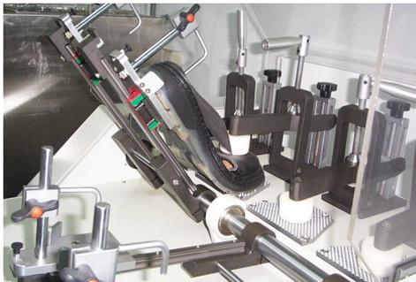
圖 1、鞋類彎折試驗機
