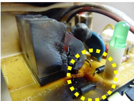
圖 3-39 ↑ 除濕機事故案例電容發生內部金屬熔出情形
