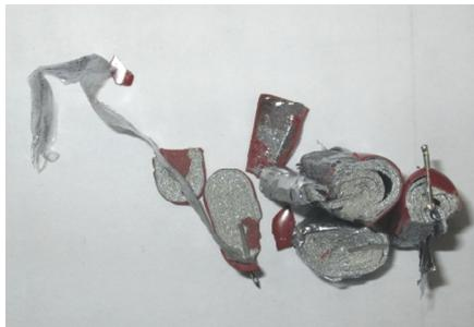
圖 2-4 ↑ 將金屬薄膜電容切開後之內部
