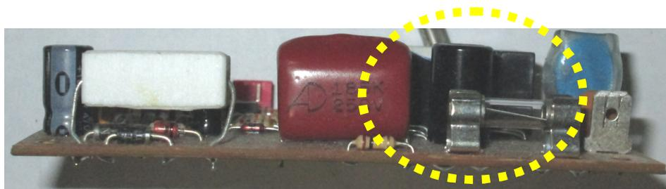
圖 2-14 ↑ 圖 2-12 類型之電路板 (黃色圓圈處為 MC1)
