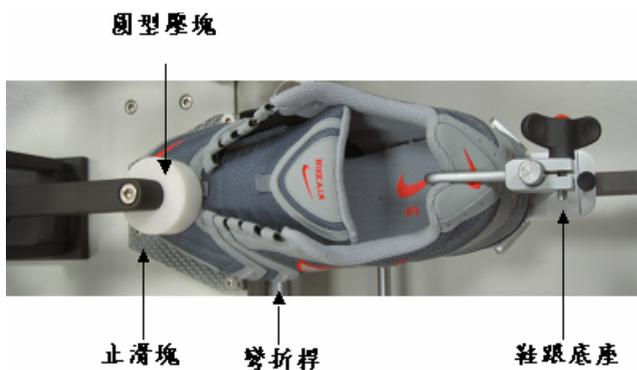
圖 3、鞋子本體於試驗機上置放卡固狀況
