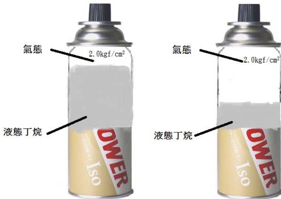
圖2-11溫度20°C時蒸汽壓均為2.0kgf/cm<sup>2</sup>
