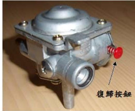
圖2-5內部阻斷式(內截式)穩壓器
