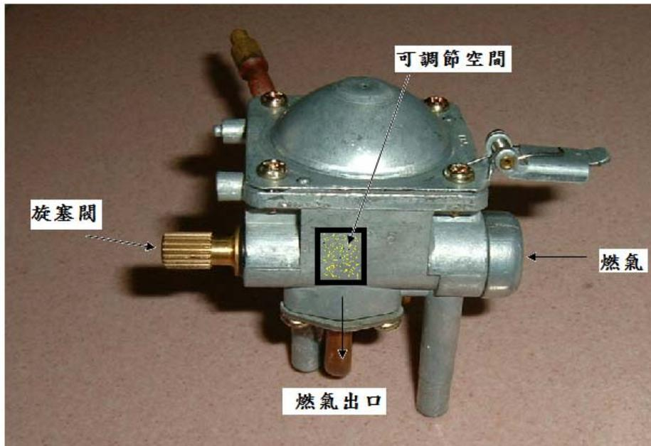
圖2-4旋塞閥工作示意
