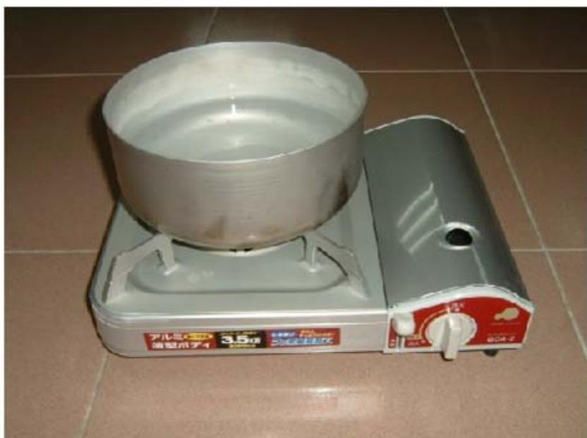
圖3-2.燃氣消耗量試驗器具裝置圖例
