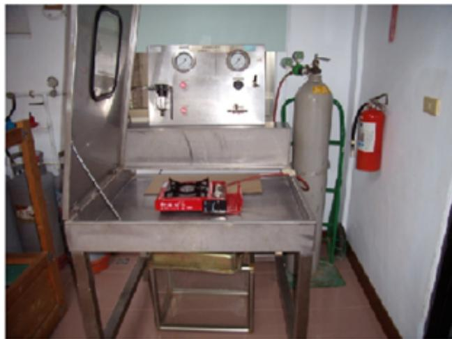
圖3-1耐壓、氣密性能試驗(a)裝置示意(b)圖例
