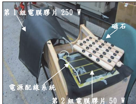
b.內部結構(側面電膜 250 W;踏板電膜 50 W)
