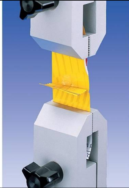
▲剝離測試示意圖
