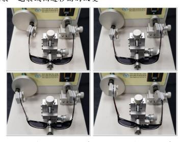
圖2 旋轉盤在不同位置時太陽眼鏡鏡架之扭曲情形
